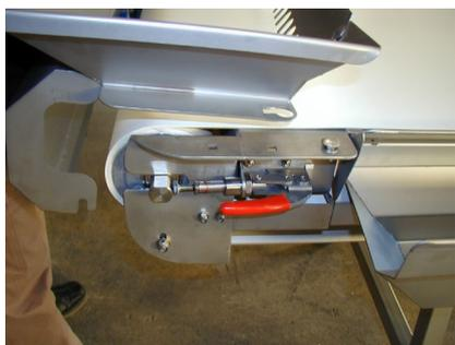
Desmontaje de la tolva de salida
